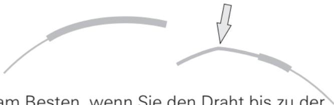
Das geht am Besten, wenn Sie den Draht bis zu der Knickstelle in das Röhrchen schieben und über dessen Rand biegen.
